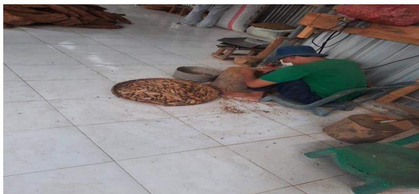
Gambar 2. Seorang pekerja sedang mengukir kayu gaharu. Pekerja menggunakan masker tapi belum memakai sarung tangan dan sepatu kerja. Pekerja juga bekerja dengan posisi yang tidak ergonomis.
